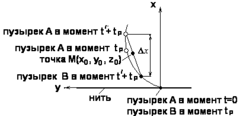
Рис. 5. - Схема движения пузырьков в переменном поле скоростей потока
